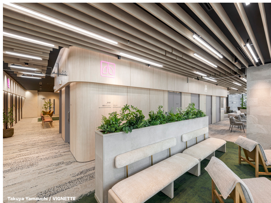
③ネオン風ピクトサイン(胸部レントゲン)／H400×W394×D15mm ベース：12 中拡散アクリル クリア塗装 ピクトは全てオリジナルデザイン。各検査室内の 1 面に、④アクセントクロスを設定しており、検査室入口上部の下がり壁に設置したネオン風ピクトサインの色味は、そのクロスに近い色味に調光している。
