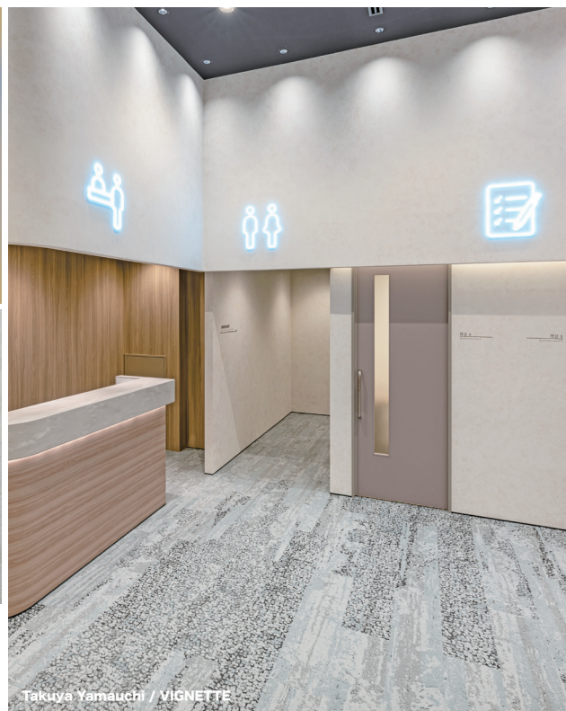
①ネオン風ピクトサイン (身体計測) / H400×W191×D15mm ②同(聴力検査) / H400×W396×D15mm ベース: 12φ拡散アクリル クリア塗装 サーカディアンリズムに合わせて、照明の色温度が変化。様々なデザインの椅子や豊かな植栽、ヒーリング効果を発揮する3D音響により、利用者がリラックスできる滞在空間を創出した。デザインだけでなく、環境配慮も意識し、壁装材にはリサイクル材、カーペットは再生糸などを使用している。
