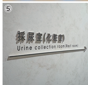
③ネオン風ピクトサイン (採尿室・化粧室) / H400×W369×D15mm ④同(問診室) / H400×W359×D15mm ベース: 12φ拡散アクリル クリア塗装 ⑤壁面誘導サイン / H90×W485×D5mm ベース: 樹脂製文字 ⑥室名サイン / H60×W240×D0.1mm 表示: マーキングフィルム 渋谷という立地特性を考慮し、室名サインは2カ国語表記を採用した。
