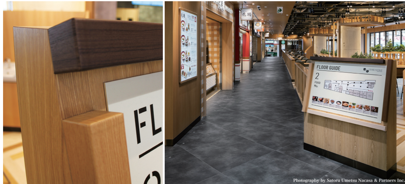
フロアガイド / H1820×W1200mm ベース：メラミン化粧板 マップサイン：アルミ複合板+インクジェット出力シート小口巻込貼 木目調メラミン化粧板に、濃淡の異なる木目シート貼った装飾部材を取り付けることでアイキャッチ効果を高めた。
