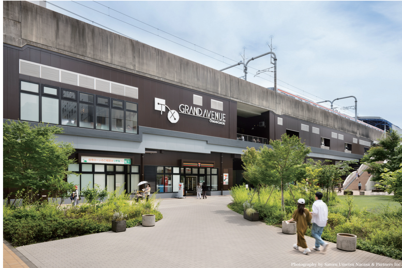
施設名称サイン（流山おおたかの森駅・北出口側）／H1965×W8855×D80mm ベース：ステンレスヘアライン 光源：内照式LED
