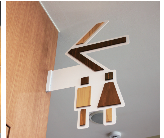
ピクトサイン (突出し) / H595×W395×D5mm ピクト：合板カットアウト+染色塗装+艶消 ベース：スチール焼付塗装仕上げ
