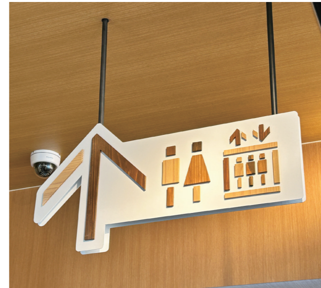
ピクトサイン (吊り) / H380×W760×D5mm ピクト：合板カットアウト+染色塗装+艶消 ベース：スチール焼付塗装仕上げ
